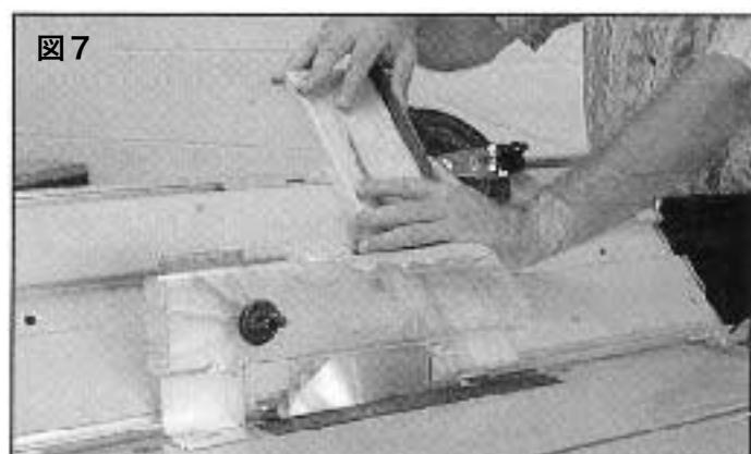
※注意:マイターゲージがワークパネルの端から端までスムーズにスライドすることを確認してください。必要なら溝下のネジを緩めることで溝の幅が調整できます。(図8参照)
