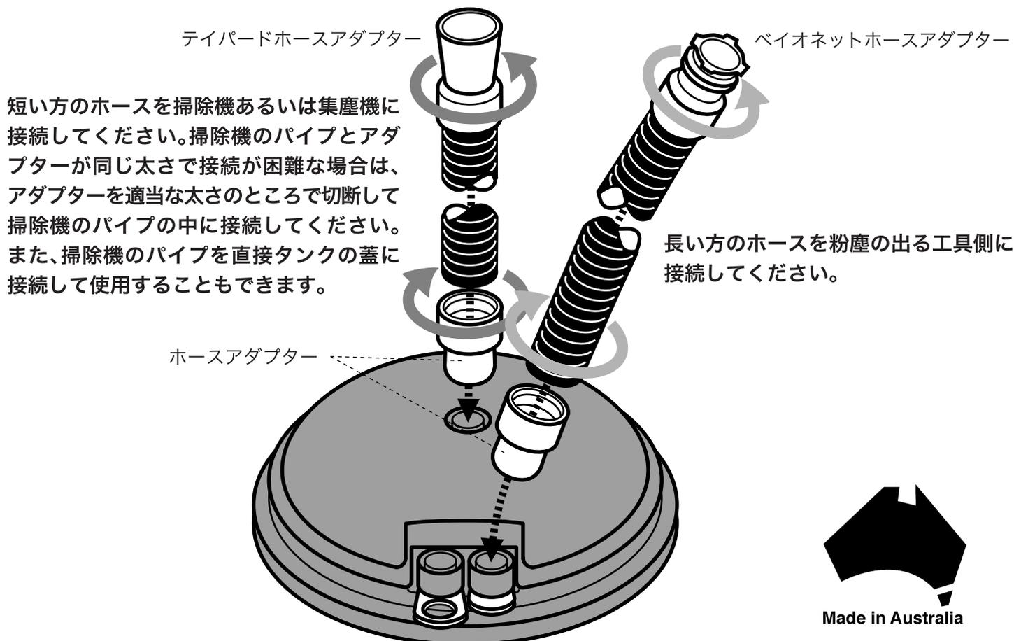
短い方のホースを掃除機あるいは集塵機に接続してください。掃除機のパイプとアダプターが同じ太さで接続が困難な場合は、アダプターを適当な太さのところまで切断して掃除機のパイプの中に接続してください。また、掃除機のパイプを直接タンクの蓋に接続して使用することもできます。
