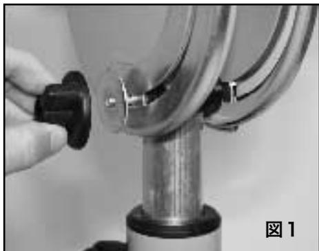
六角ボルトM6×80mm(J)をワッシャー金具(I)のツメにかみ合うように合わせながら、リアパネルの溝に入っているワッシャーに挿し込み、ボルトが下側のサドルの穴を通り抜けフロントパネルの溝に入っているワッシャーから突き出すようにします。
