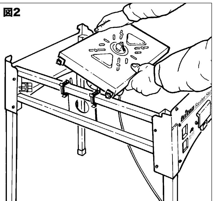
スライドプレートのナイロンベアリング部が、フレーム内側にピッタリと収まるはずです。(図3参照)
