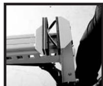
1回のペダル踏み込みで約25mmプレスします。
