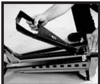
3. 前脚(6)を持ち上げます。十分開いたら前脚ロックノブ(9)を時計回りに締めて図のように丸い部分がハウジング上に来るよう脚をしっかりと固定します。
