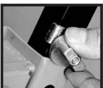
▲ 最初のセットアップ時は、脚を固く締め付けるためにはノブを数回まわす必要があります。折りたたむ時には、半回転する程度で解除することができます。
