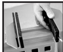
2. スライドジョーのフェースを取り外すには、まずジョーの後側のフェースを本体フロント側から見て右側に押して、固定ピンを外します。
